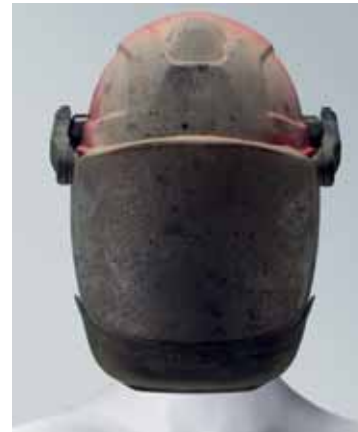
7 kA kısa devre elektrik arka göre
